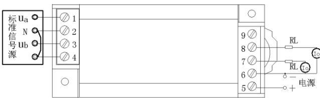
图 6、电流输出产品精度试验接线图
